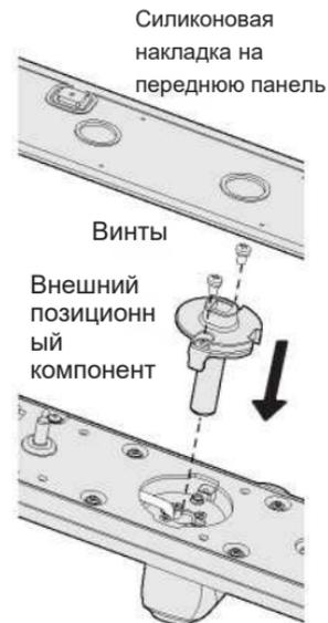
Вставьте кабель в нужный конец, затем установите позиционный компонент в правильном порядке и, наконец, затяните винты.
