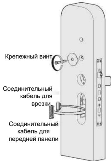
5. Установите монтажную пластину с помощью крепежных винтов, плотно прижав ее к поверхности двери, чтобы зафиксировать переднюю панель.
